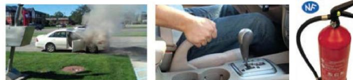
*Couper le moteur et serrer le véhicule. Ouvrir le capot
